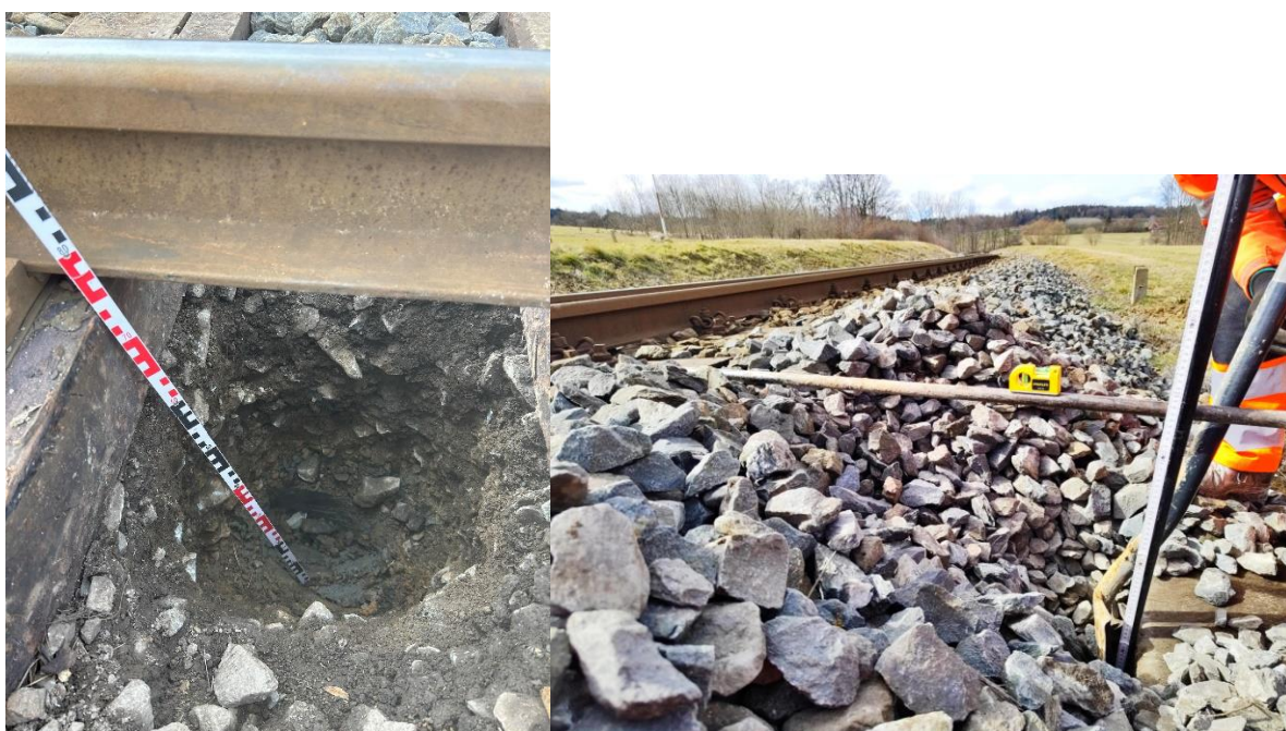
Kopaná sonda KS1 a měření mocnosti kolejového lože nad propustkem.
